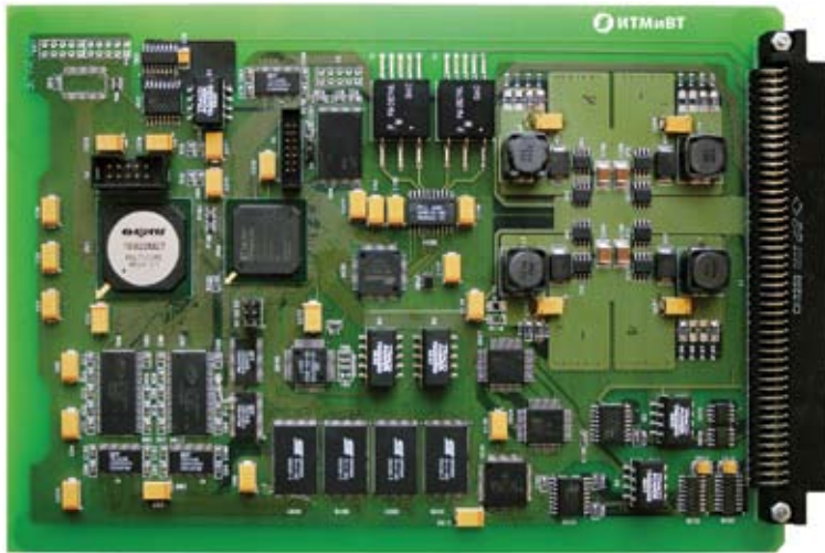
Процессорный модуль для цифровой системы автоматического управления газотурбинным двигателем
